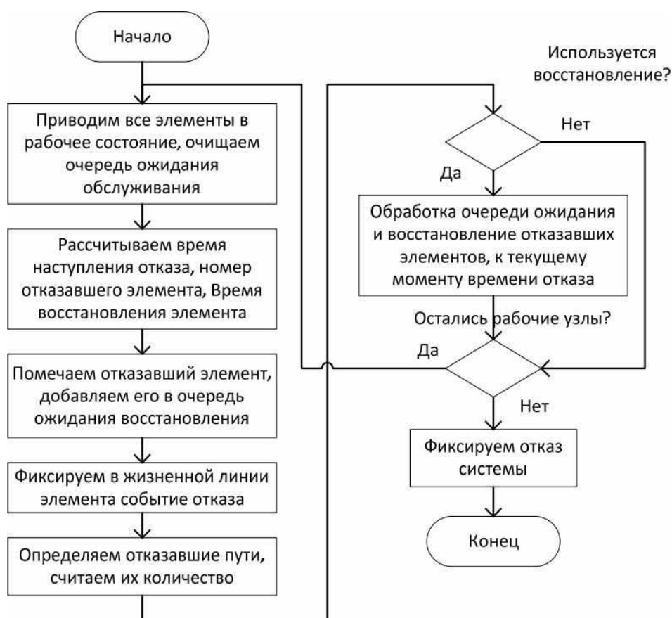
Рисунок 6 - Обобщенный алгоритм работы единичной итерации моделирования отказа инфокоммуникационной системы
