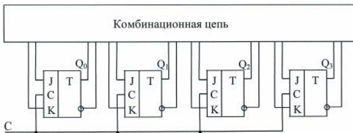
Рисунок 1 – Схема 4-разрядного счетчика на JK-триггерах
