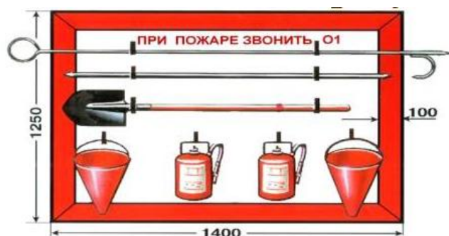
Рисунок 6 - Пожарный щит первичных средств пожаротушения
