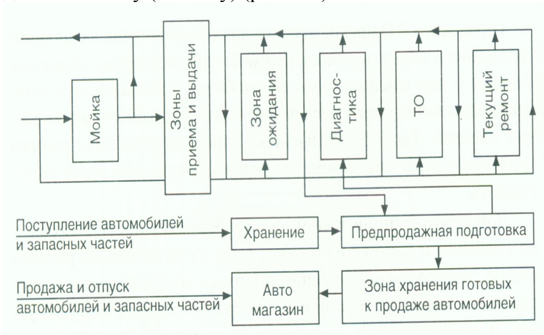
Рис. 4.3. Схема технологического процесса на СТОА
