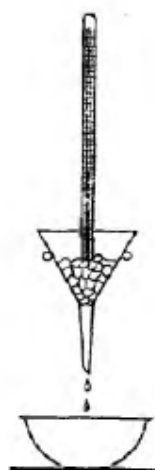
Рис.10. Установка для поверки нулевой точки термометра
