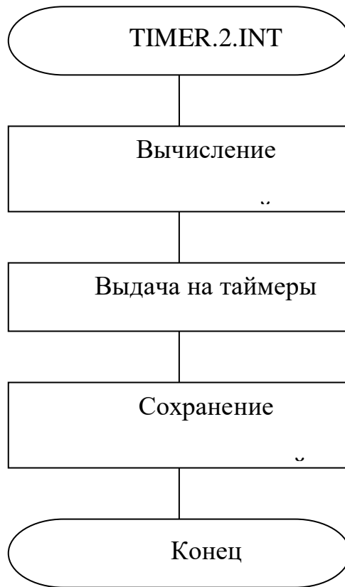
Рис.21 Обработчик прерывания таймера №2. Вычисление текущих управляющих воздействий
