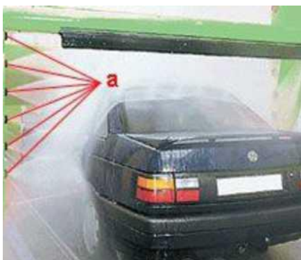
Рисунок 1.6 – Работа рамки с распылителями: а - распылители
