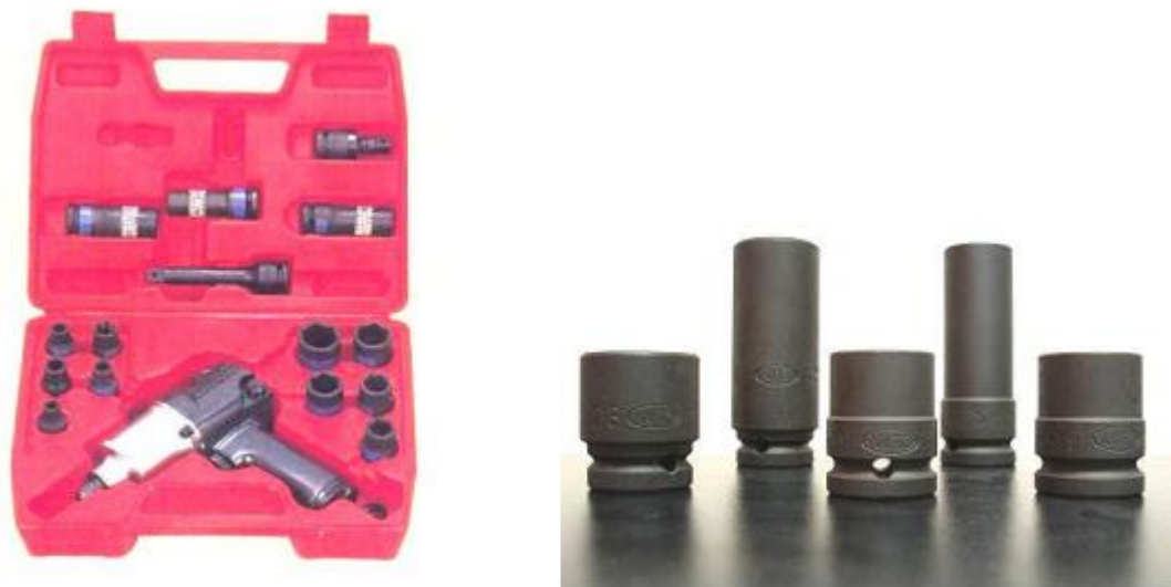
Рисунок 4.23 – Пневмогайковерт с набором сменных головок и переходников
