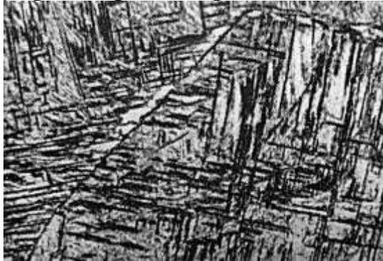
Рис.13.3. Микроструктура металла шва сплава ВТ5 ( \times 300 )
