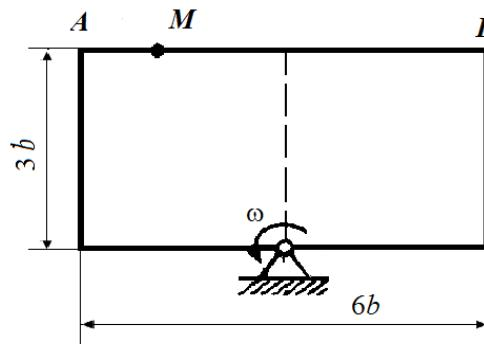
скоростью  $\omega$  по закону, приведенному на рисунке (при знаке минус направление  $\omega$  противоположно показанному на рисунке). Относительно этого тела из положения  $A$  в положение  $B$  движется точка  $M$ , закон её относительного движения  $S=f(t)$  или закон изменения относительной скорости  $V_{\text{отн}}=f(t)$  которой также известен. Для изображенного на рисунке положения точки, соответствующего заданному моменту времени  $t$ , определить ее абсолютные скорость и ускорение.
