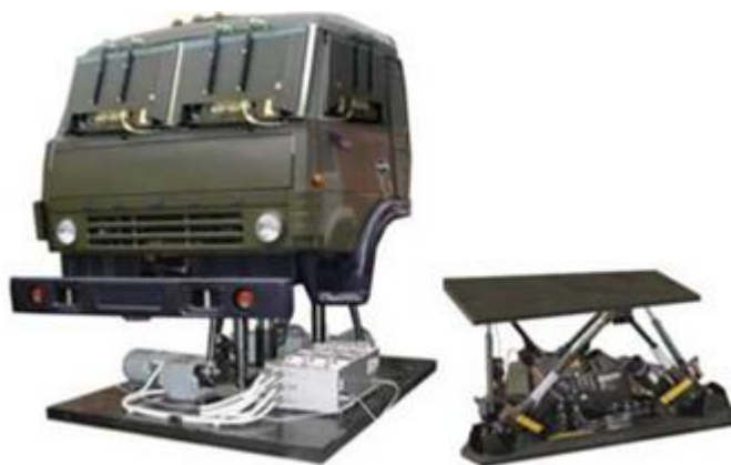
Рис. 5. Тренажер КАМАЗ 4350/5350 на динамической электромеханической платформе
