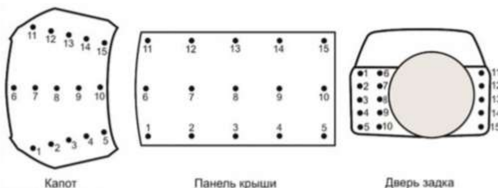
Рис. 2 – Схема контроля лакокрасочного покрытия на горизонтальной поверхности кузова
