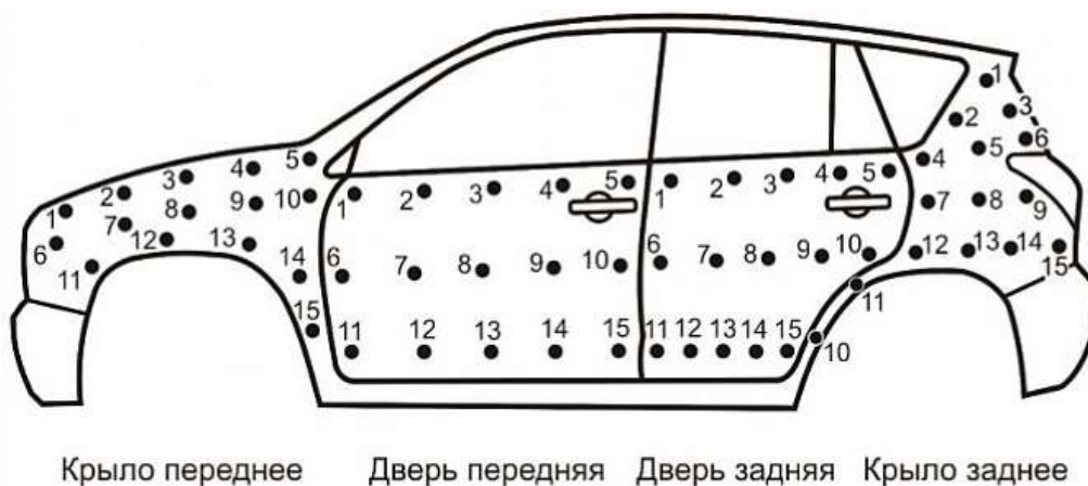
Рис. 1 – Схема контроля лакокрасочного покрытия на боковой поверхности кузова
