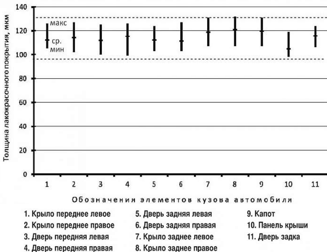
Рис. 3 – Примерные статистические характеристики толщины лакокрасочного покрытия кузова автомобиля
