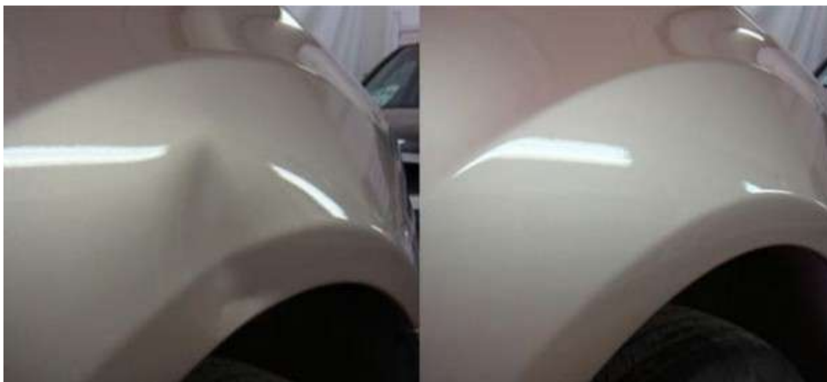
Рис. 2 - Пример работы по устранению вмятины на крыле автомобиля в районе колёсной арки по технологии PDR.
