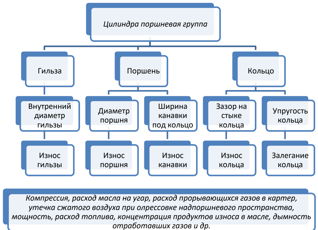
Рисунок 1.4– Структурно-следственная схема цилиндропоршневой группы двигателя как объект диагностирования
