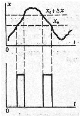
Рисунок 3 – Принцип измерения плотности вероятности
