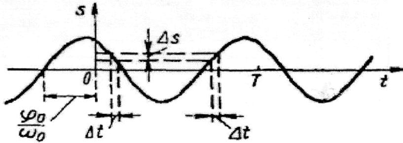
Рисунок 4 – Гармоническое колебание с равномерно распределённой фазой
