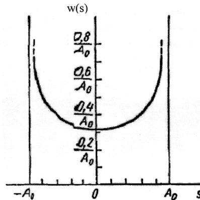
Рисунок 5 – Плотность вероятности гармонического колебания с равномерно распределённой фазой
