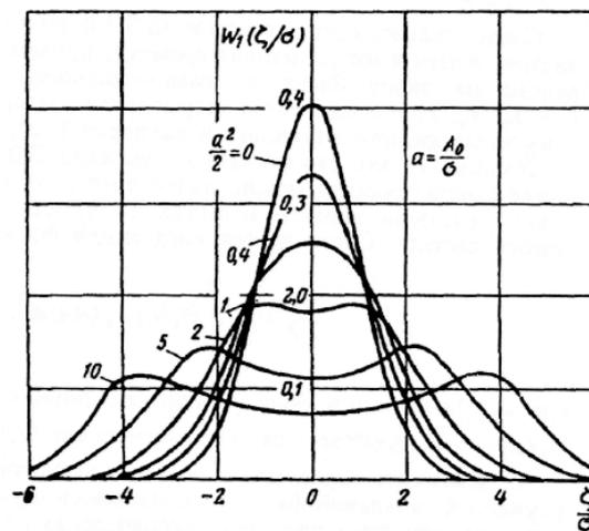
Рисунок 6 – Плотность вероятности суммы нормального шума и гармонического сигнала со случайной начальной фазой.
