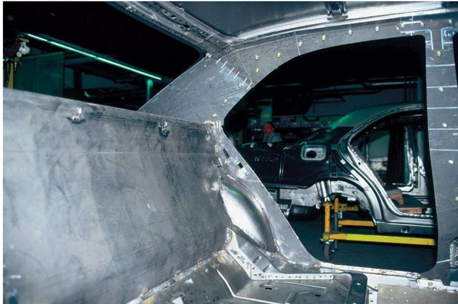
Рис. 16 Бронирование кузова в соответствии с категорией В6/В7
