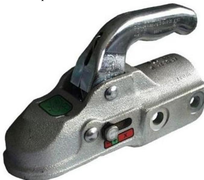
Рис. 8 Сцепная головка прицепа
