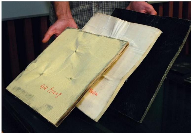
Рис. 17 Многослойные композитные пластины
