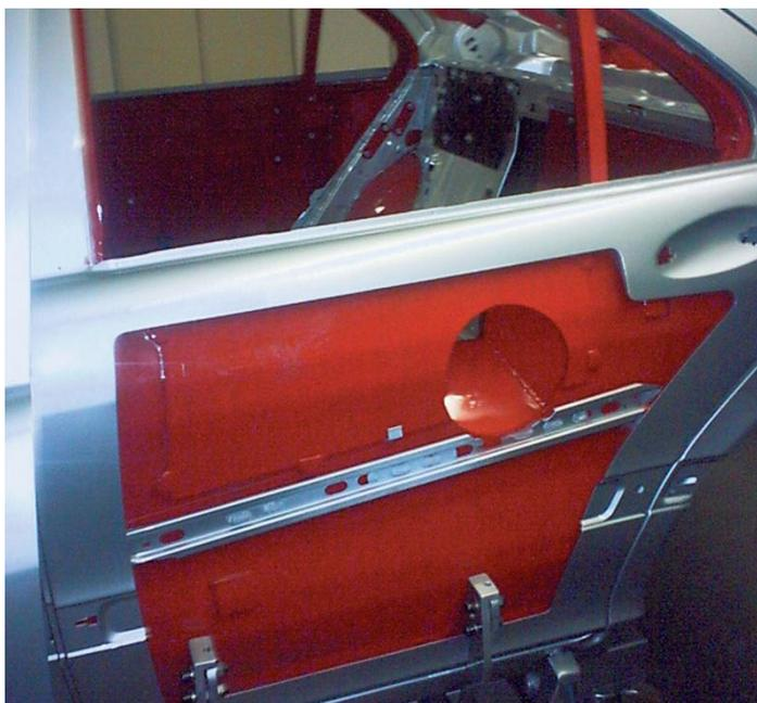
Рис. 18 Бронированная дверь автомобиля с бойницей
