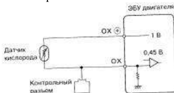
Рис. 2.1(б). Схема включения титанового кислородного датчика
