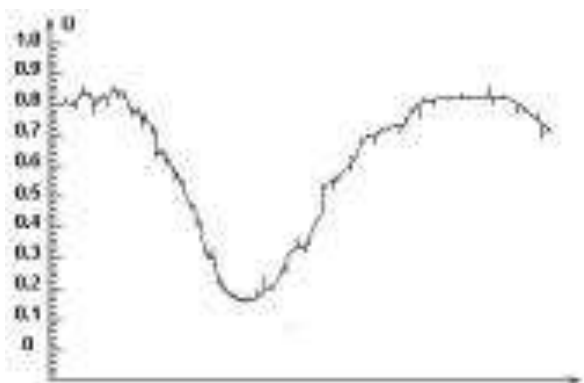
Рис. 2.5(в). Датчик с существенными признаками старения
