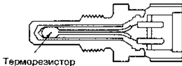
Рис. 1.1. Конструкция датчика температуры
