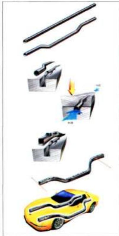
*Метод гидроформования для изготовления стальных кузовов. На рисунке показана последовательность создания лонжерона кузова методом гидроформования*
