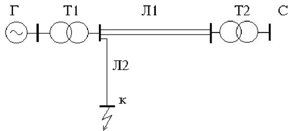
$\Gamma$ :  $P = 6 \times 63 \text{ Мвт}$     $T1$ :  $S = 4 \times 125 \text{ МВА}$     $T2$ :  $S = 2 \times 250 \text{ МВА}$     $C$ :  $U_c = 230 \text{ кВ}$
