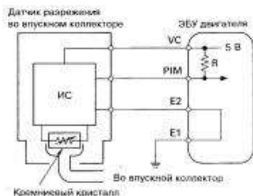
Рис. 1.6(а). Схема включения датчика абсолютного давления коллектора
