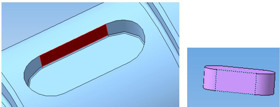
А затем выделите боковую сторону шпонки, предварительно повернув сборку для удобства при зажатом колесике мыши.
