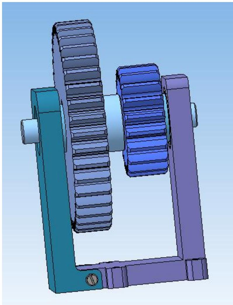
Для расположения стоек в вертикальной плоскости воспользуйтесь сопряжением *Параллельность* . Укажите боковую плоскость любой из стоек *Плоскость XY* в дереве модели, которые должны быть параллельны.
