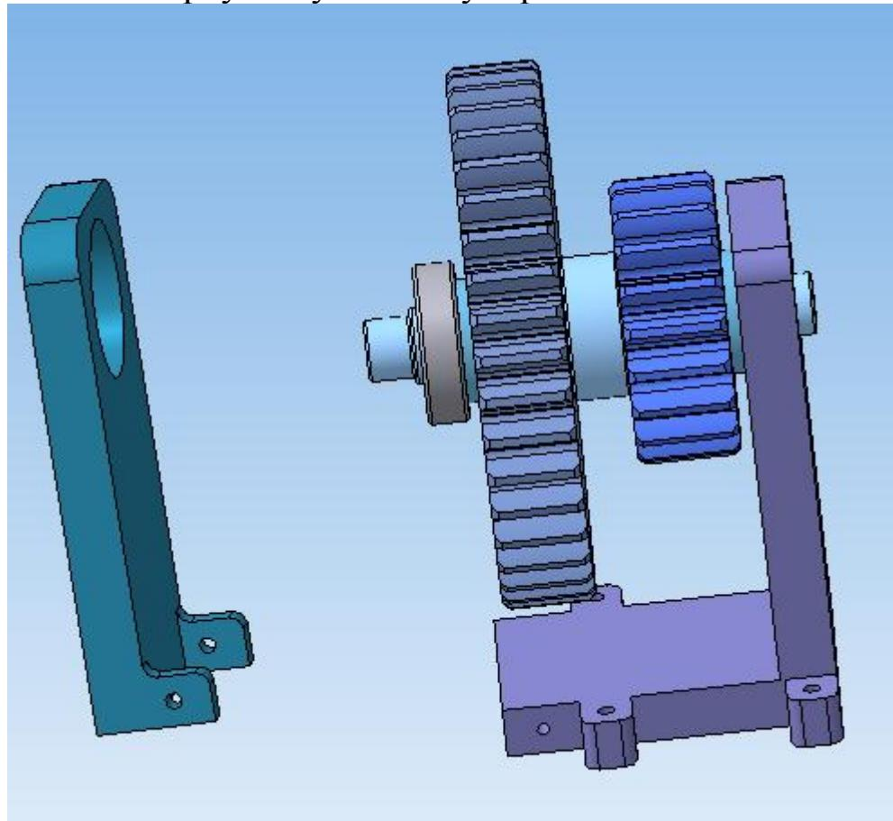
Задайте сопряжение *Соосность* между Валом и отверстием под подшипник в Левой стойке.
