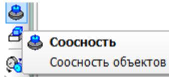
Вначале укажите цилиндрическую поверхность вала, а затем – колеса.
