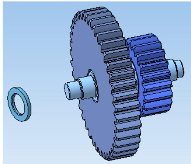
Задайте сопряжение компонентов. Вначале выполните команду *Соосность* вкладки *Сопряжения* , указав цилиндрические поверхности вала и втулки.
