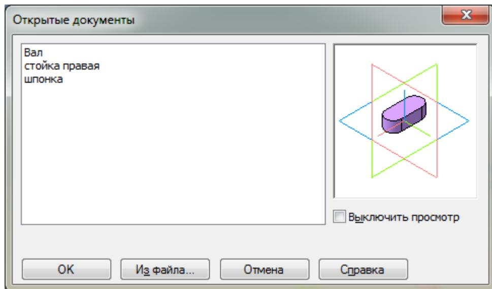
Если необходимой детали в списке нет (т.е. файл детали не открыт), то нажмите кнопку *Из файла* и выберите деталь. Обычно в качестве первого выбирают тот компонент сборки, к которому удобнее добавлять все прочие компоненты (в рассматриваемом примере – вал). Часто процесс создания сборки повторяет реальные сборочные операции.
