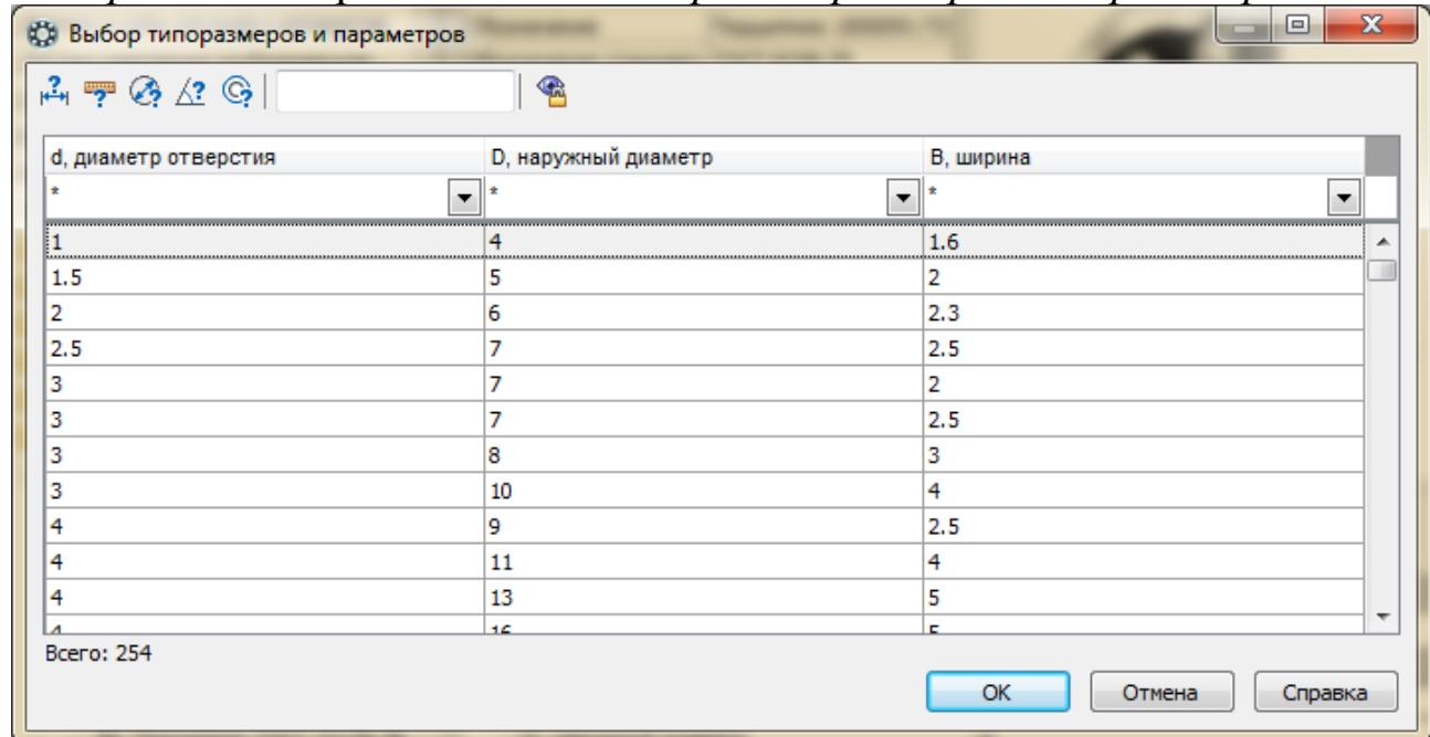
Выберите требуемый подшипник (в рассматриваемом случае с диаметром отверстия  $d=30$  мм, наружным диаметром  $D=62$  мм и шириной  $B=16$  мм).
