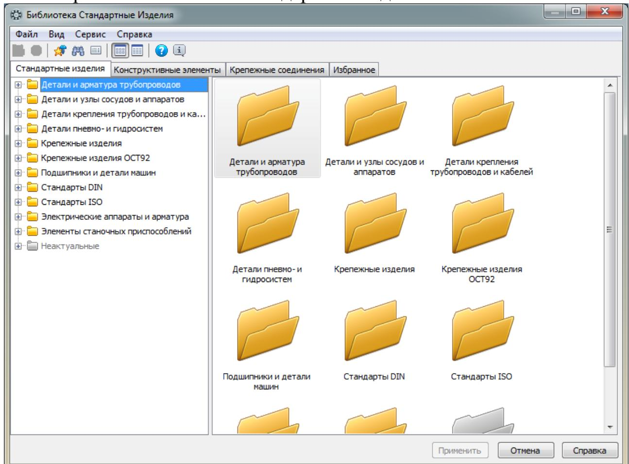
В дереве библиотеки выберите *Подшипники и детали машин* → *Подшипники качения* → *Тип 0. Радиальные шариковые* → *Подшипник ГОСТ 8338-75*. Дважды нажмите левой кнопкой мыши на выбранный тип подшипника.
