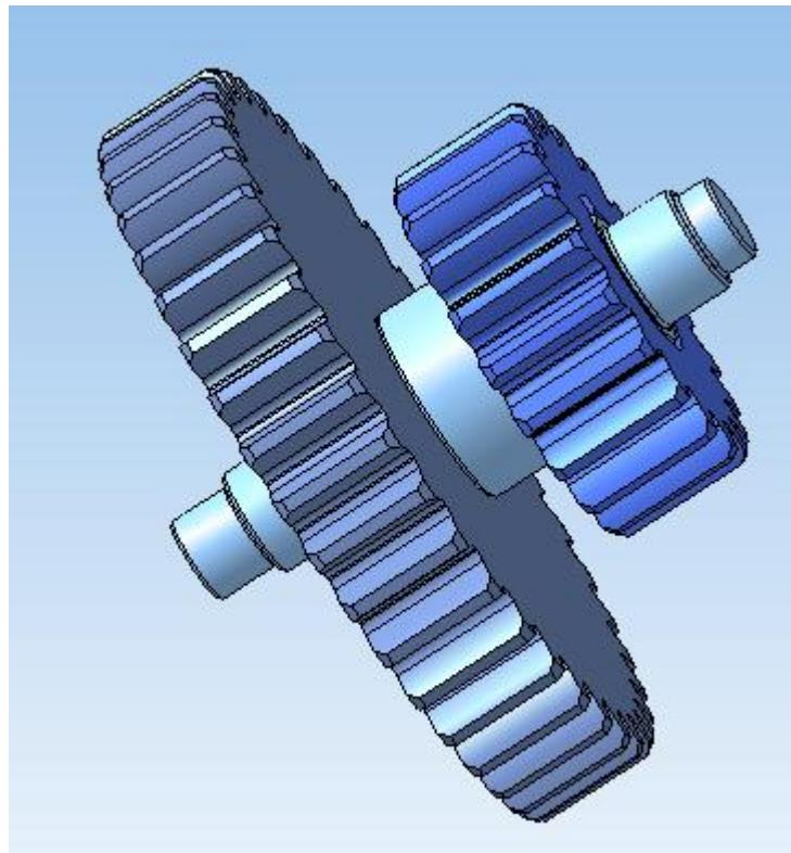
Установите на ступенях вала № 2 и № 6 втулки, фиксирующие зубчатые колеса в осевом направлении и предотвращающие трение боковой поверхности колес о стойки. Добавьте в сборку компонент Втулка, используя команду
