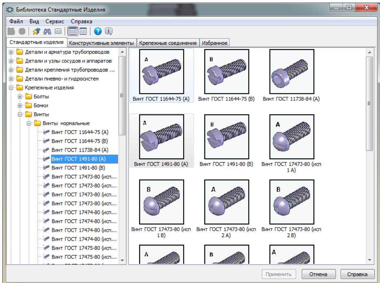
Выберите диаметр резьбы 6 мм и длину винта 20 мм и нажмите **OK**.
