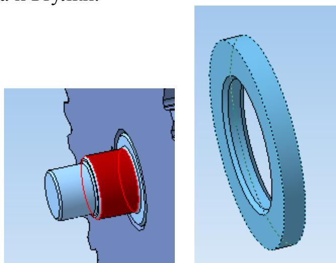
После этого задайте *Совпадение* боковой поверхности ступени вала, на которой установлено зубчатое колесо, и боковой поверхности втулки.
