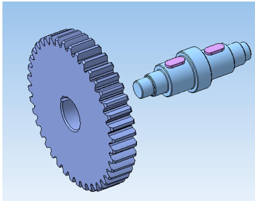
Задайте привязку *Параллельность*
