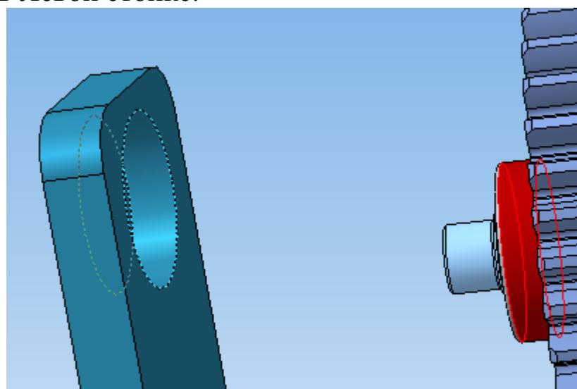
Установите *Соосность* между резьбовым отверстием в Правой стойке и крепежным отверстием в Левой стойке.
