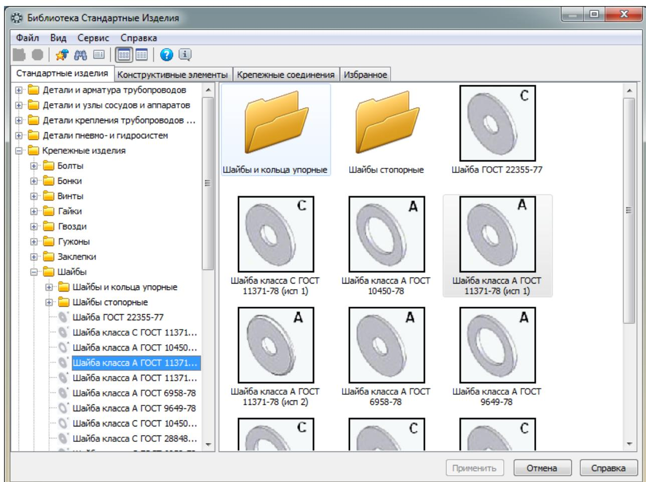
Выберите шайбу с диаметром крепежной детали 6 мм и нажимаем OK.
