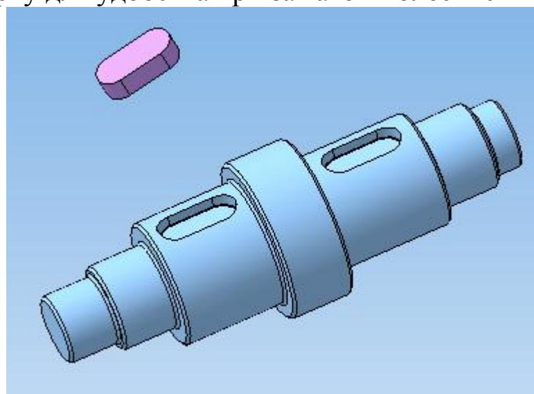
После этого укажите совпадение между скругленной частью шпоночного паза и соответствующей поверхностью шпонки.
