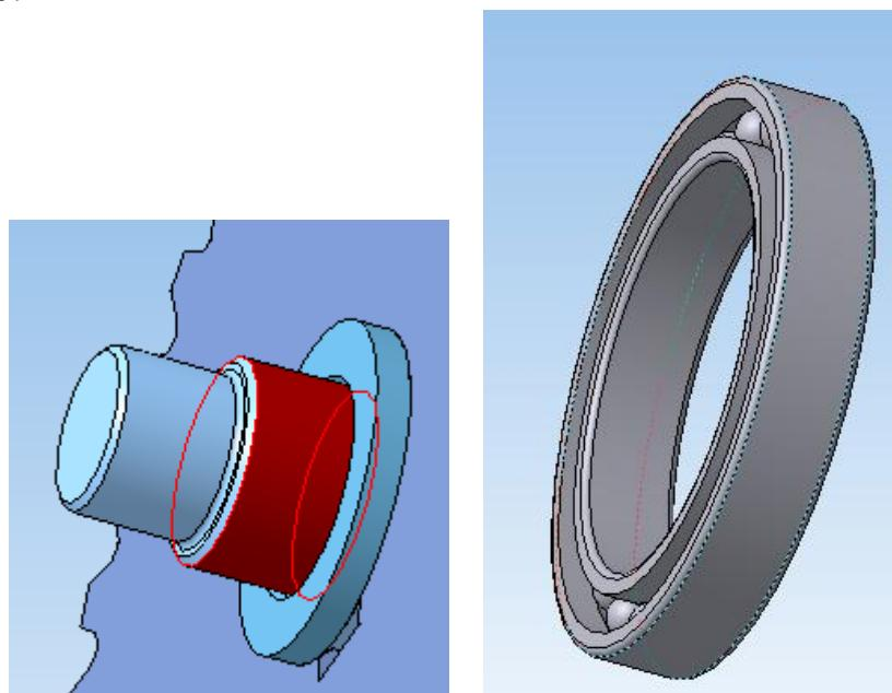
Нажмите кнопку *Совпадение объектов*
