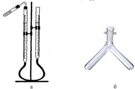
Рисунок – Прибор для определения объема водорода (a), двухколенная пробирка (сосуд Ландольта) (б).
