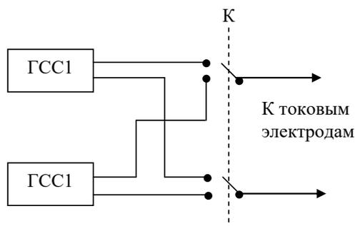
Рис. 1. Схема переключения генераторов синусоидальных сигналов (ГСС1 и ГСС2) Аналогично переключаются фильтры, настроенные на различные частоты при их подключении к аналогово-цифровому преобразователю.
