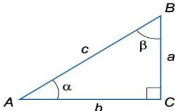
противолежащий катет  $b$  - стойка, прилежащий катет  $a$  - половина балки перекрытия, гипотенуза  $c$  - стропило,  $\angle A$  - угол наклона крыши.
