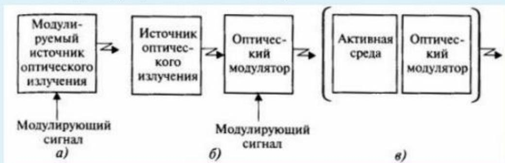
внутренняя модуляция, при которой преобразование излучения происходит в процессе его формирования непосредственно в источнике оптического излучения
