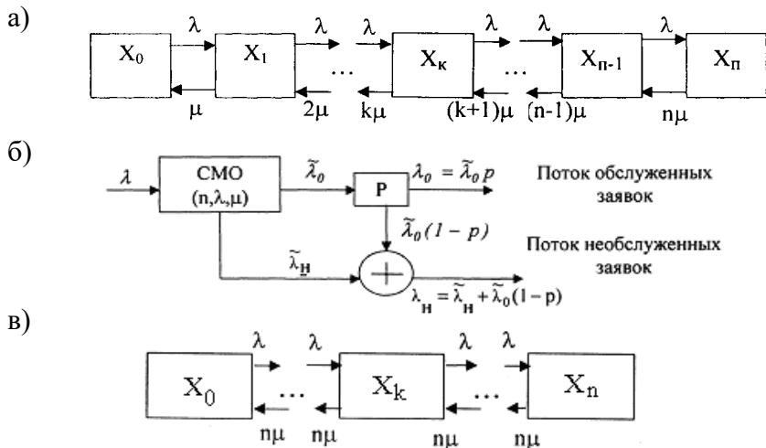
32. Если поступившая на обслуживание в СМО с отказами и частичной взаимопомощью между каналами заявка застает все каналы свободными, то она принимается на обслуживание и обслуживаеться одновременно  $\ell$  каналами причем...
