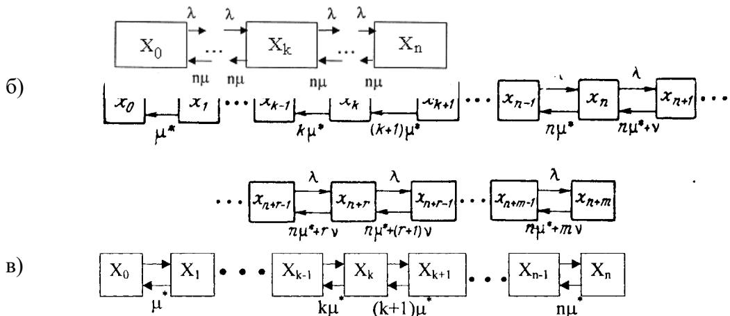
77. Граф состояния СМО с ожиданием, ограниченным временем пребывания заявки в системе и упорядоченным обслуживанием
