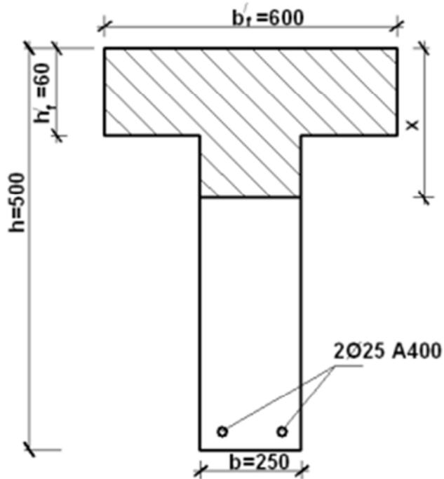
Изгибающий элемент таврового сечения с размерами:  $b = 250\text{мм}$  ,  $h = 500\text{мм}$  ,
