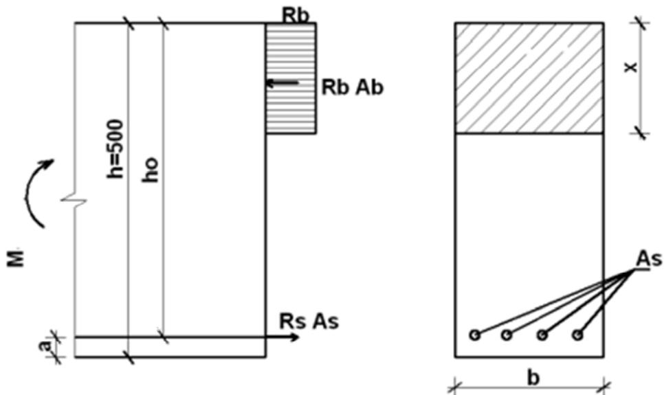
Изгибающий элемент прямоугольного сечения с размерами  $b = 200$  мм,  $h = 500$  мм.
