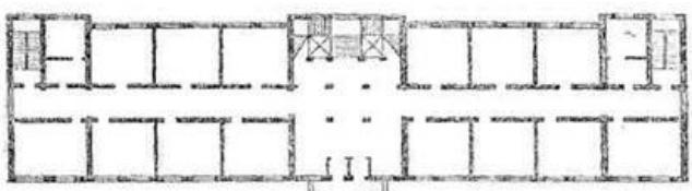
Б) Планировочная схема этажа общественного здания коридорная кольцевая
