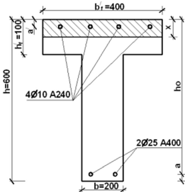
Изгибающий элемент таврового сечения с размерами:  $b = 200\text{мм}$  ,  $h = 600\text{мм}$  ,
