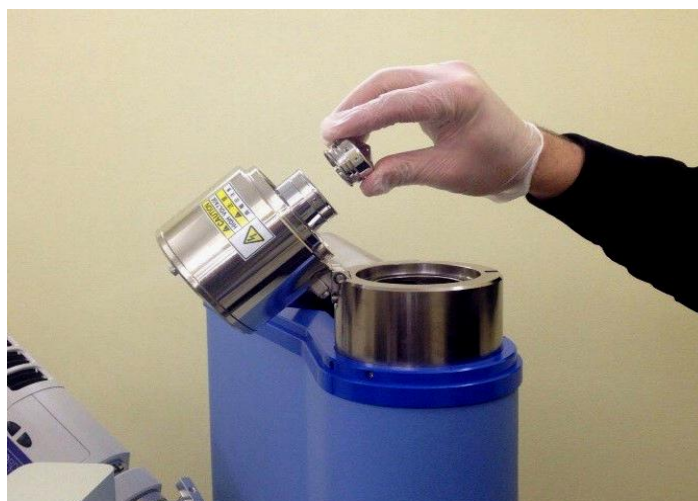
Рис. 15. Установка катода в катодный узел
