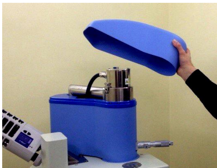
Рис. 8. Верхняя часть электронной колонны
