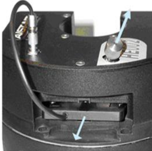
Рис. 9 Извлечение каретки зонда из измерительной головки СЗМ.
