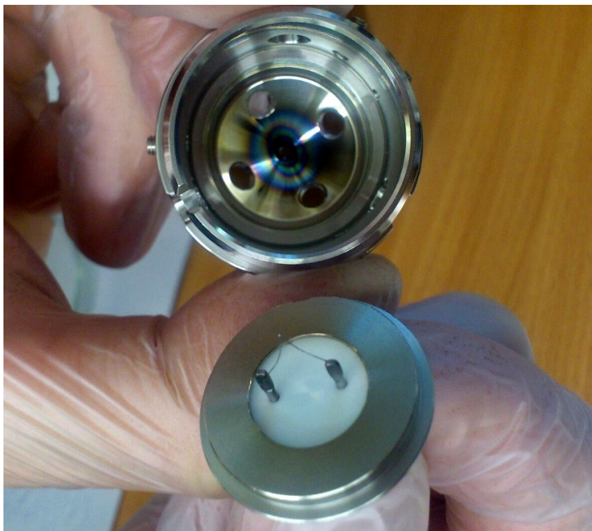
Рис. 11. Катод и корпуса электрода Венельта в разборе
