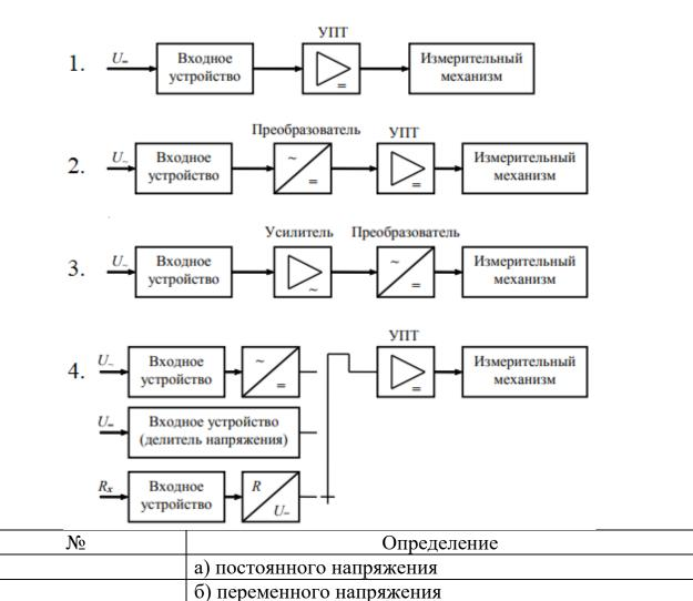
4. г) для измерения малых переменных напряжений 4.21 Установите соответствие между схемами включения измерителей
