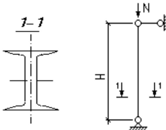
Рисунок 8 – Расчетная схема центрально сжатой колонны
