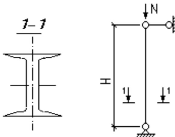
Рисунок 9 – Расчетная схема центрально сжатой колонны
