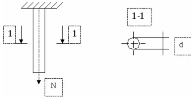
Рисунок 1 – Расчетная схема центрально растянутой подвески
