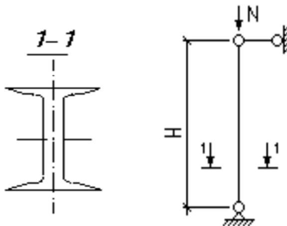
Рисунок 5 – Расчетная схема центрально сжатой колонны
