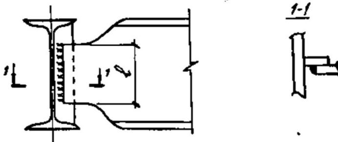
Рисунок 30 – Сварной монтажный стык балок
