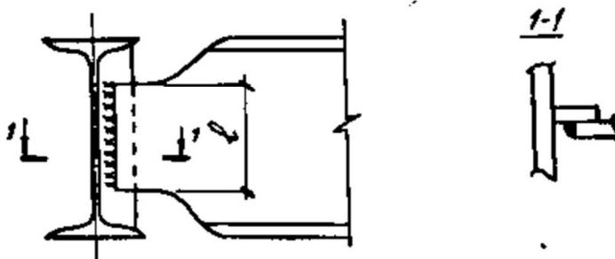
Рисунок 31 – Сварной монтажный стык балок
