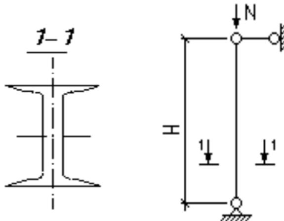
Рисунок 7 – Расчетная схема центрально сжатой колонны
