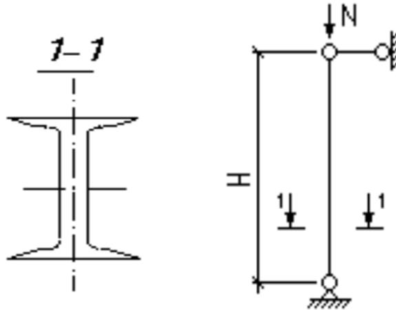
Рисунок 6 – Расчетная схема центрально сжатой колонны
