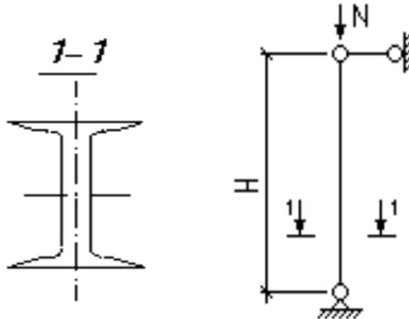
Рисунок 10 – Расчетная схема центрально сжатой колонны
