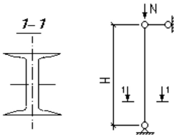
Рисунок 13 – Расчетная схема центрально сжатой колонны
