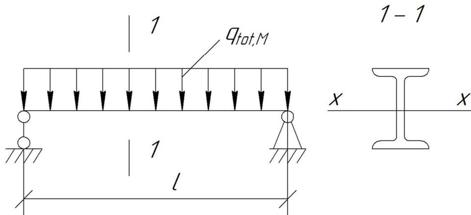
Рисунок 3 – Расчетная схема балки
