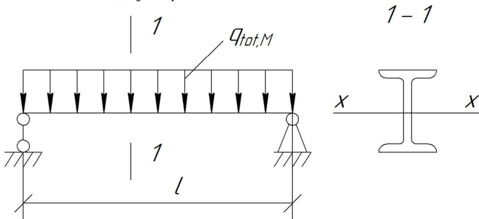
Рисунок 20 – Расчетная схема балки
