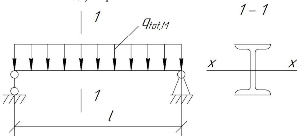
Рисунок 21 – Расчетная схема балки
