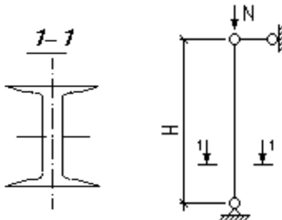
Рисунок 11 – Расчетная схема центрально сжатой колонны
