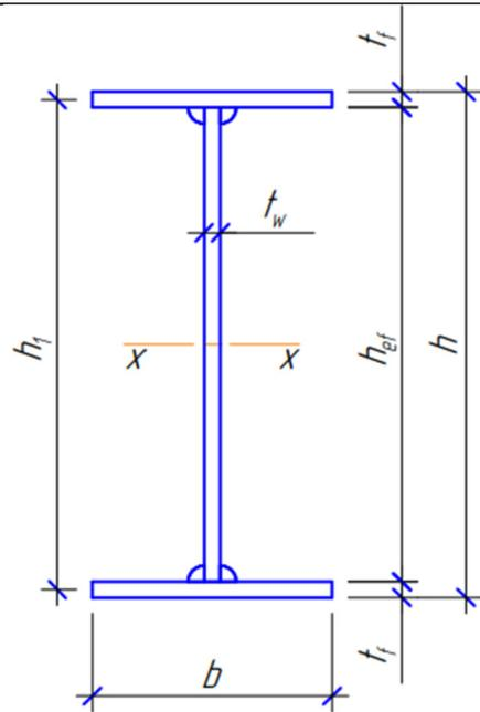
Б) Сварные двутавровые балки из двух тавров и листа (стенки)
