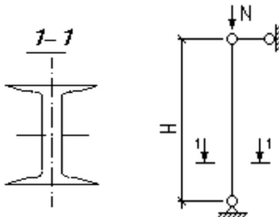
Рисунок 16 – Расчетная схема центрально сжатой колонны
