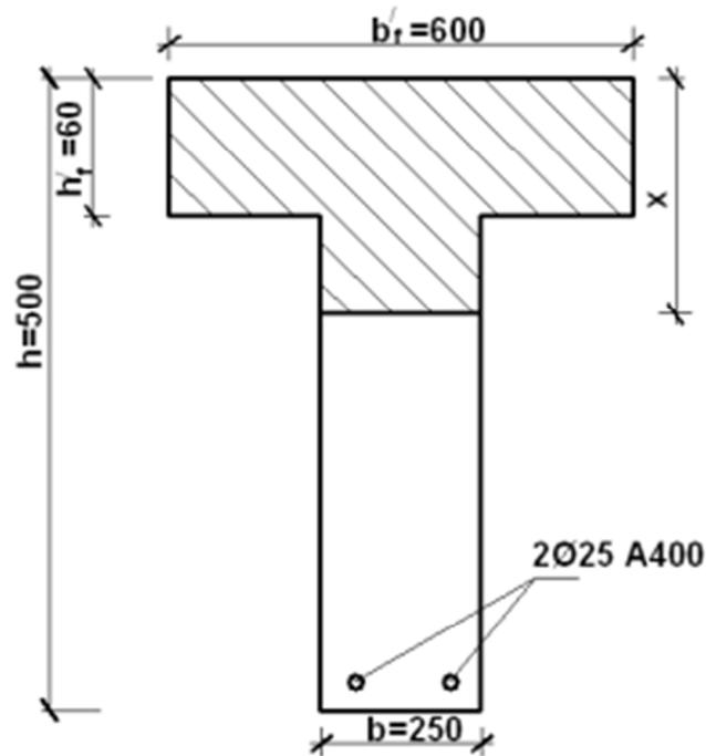
Изгибаемый элемент таврового сечения с размерами:  $b = 250\text{мм}$  ,  $h = 500\text{мм}$  ,  $b' f = 600\text{мм}$  ,  $h' f = 60\text{мм}$ .
