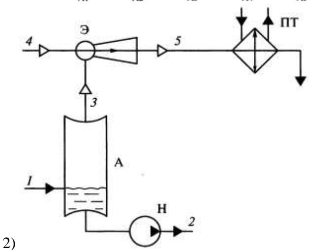
В) Утилизация теплоты низкотемпературного водяного пара с помощью ТНУ с промежуточным теплоносителем
