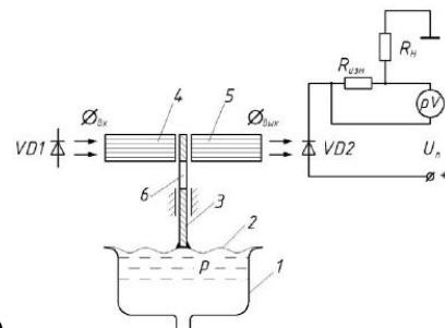
е) цифровой мембранны-оптоволоконный прибор для измерения давления
