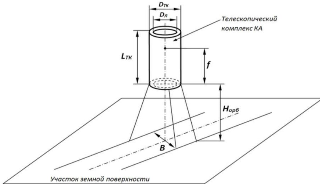
Телескопический комплекс КА:  $L_{ТК}$  - длина телескопического комплекса,  $D_{ТК}$  - диаметр телескопического комплекса,  $D_{Л}$  - диаметр оптического элемента телескопа (линзы или зеркала),  $f$  - фокусное расстояние оптической системы телескопа,  $H_{орб}$  - высота орбиты КА,  $B$  - ширина полосы обзора.
