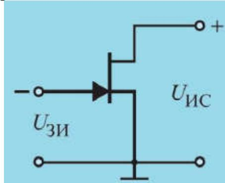
а) Схема полевого транзистора с управляющим р-п переходом с общим истоком и каналом п-типа
