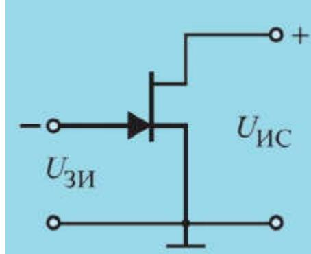
а) Схема полевого транзистора с управляющим р-п переходом с общим истоком и каналом n-типа
