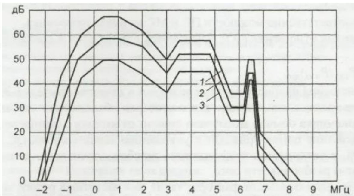
Рисунок 4 – Нормы на защитные отношения для системы SECAM K, D при помехе от гармонического колебания или ЧМ радиосигнала звука: 1 – порог заметности; 2 – хорошее качество; 3 – удовлетворительное качество
