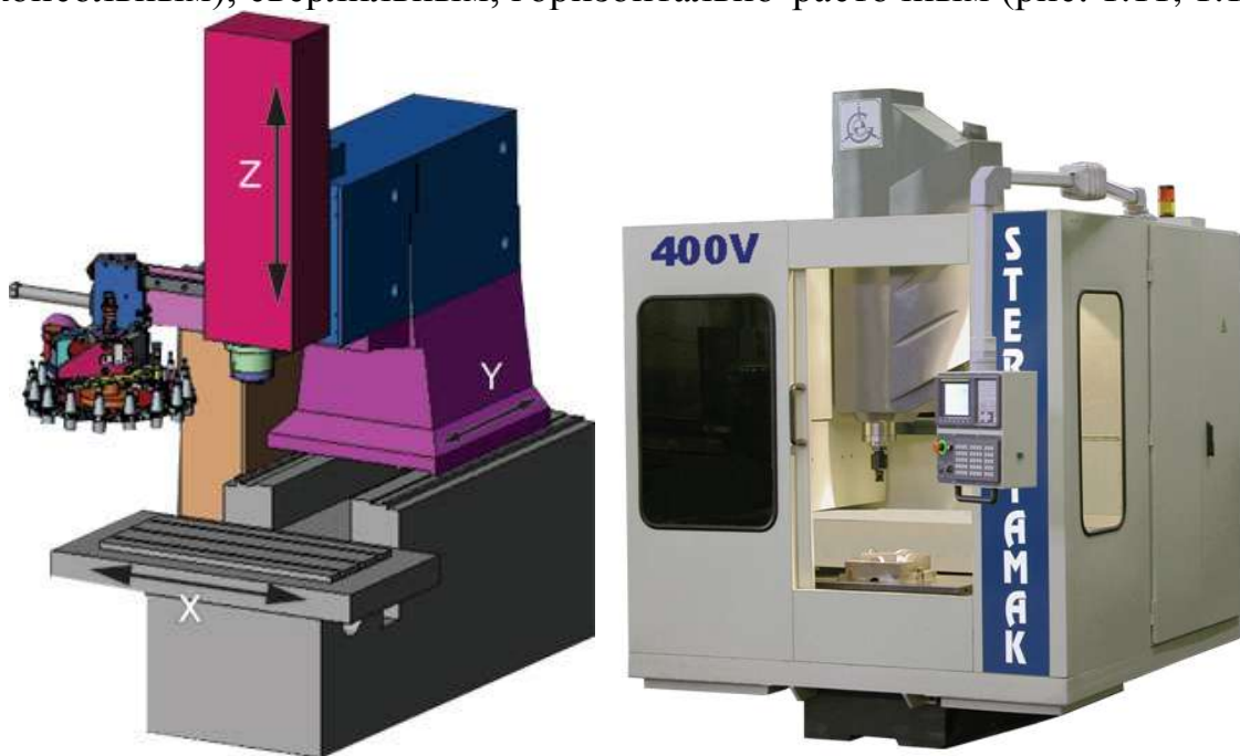
Рисунок 1.11 - Станок вертикальный сверлильно-фрезерно-расточный с ЧПУ
