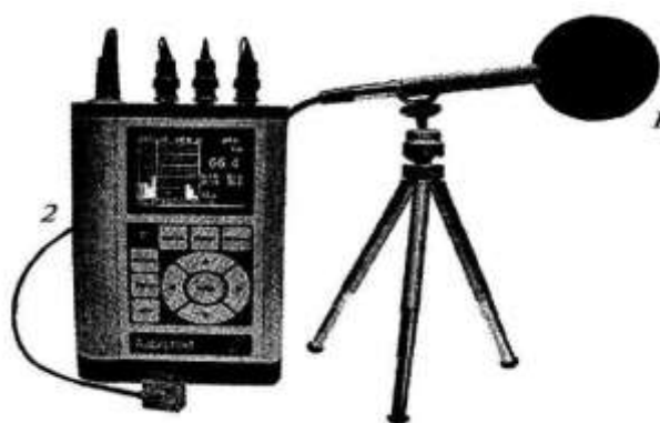
Рисунок 19. Комплект шумомера: 1 — микрофон; 2 — измерительный блок
