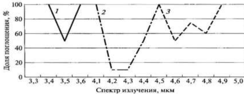
Рисунок 12. Спектр инфракрасного излучения, поглощаемый различными соединениями: 1 — углеводороды C_xH_y ; 2 — диоксид углерода CO_2 ; 3 — оксид углерода CO
