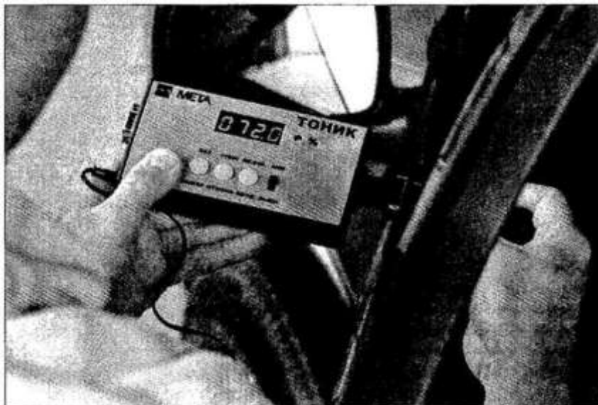
Рисунок 9. Проверка светопропускания стекол
