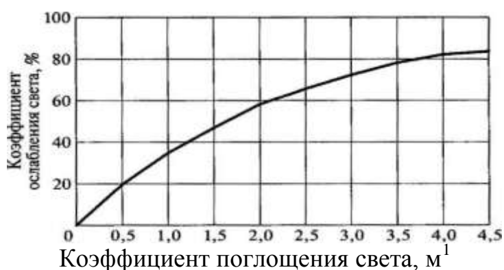
Рисунок 16. График для пересчета единиц измерения дымности
