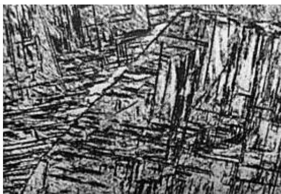
Рисунок 2.4 - Микроструктура металла шва сплава ВТ5 ( \times 300 )
