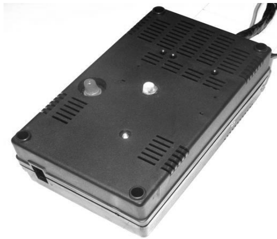
Рис. 1.2. Внешний вид вибрационного робота с подвижной поступательно движущейся внутренней массой
