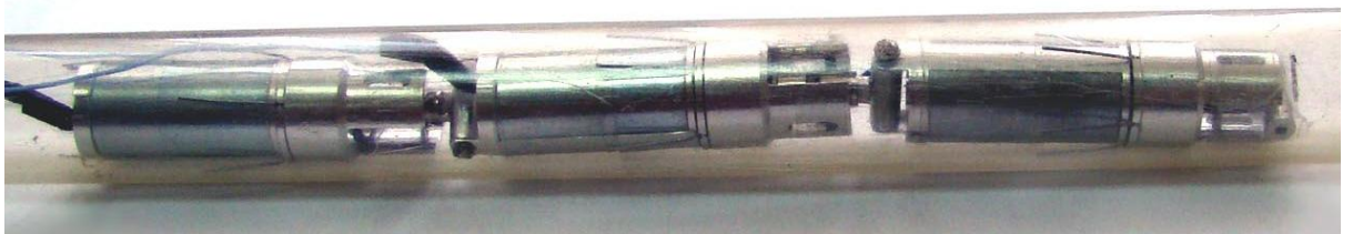
Рис. 4.1 Трехмодульный робот для перемещения внутри трубопроводов
