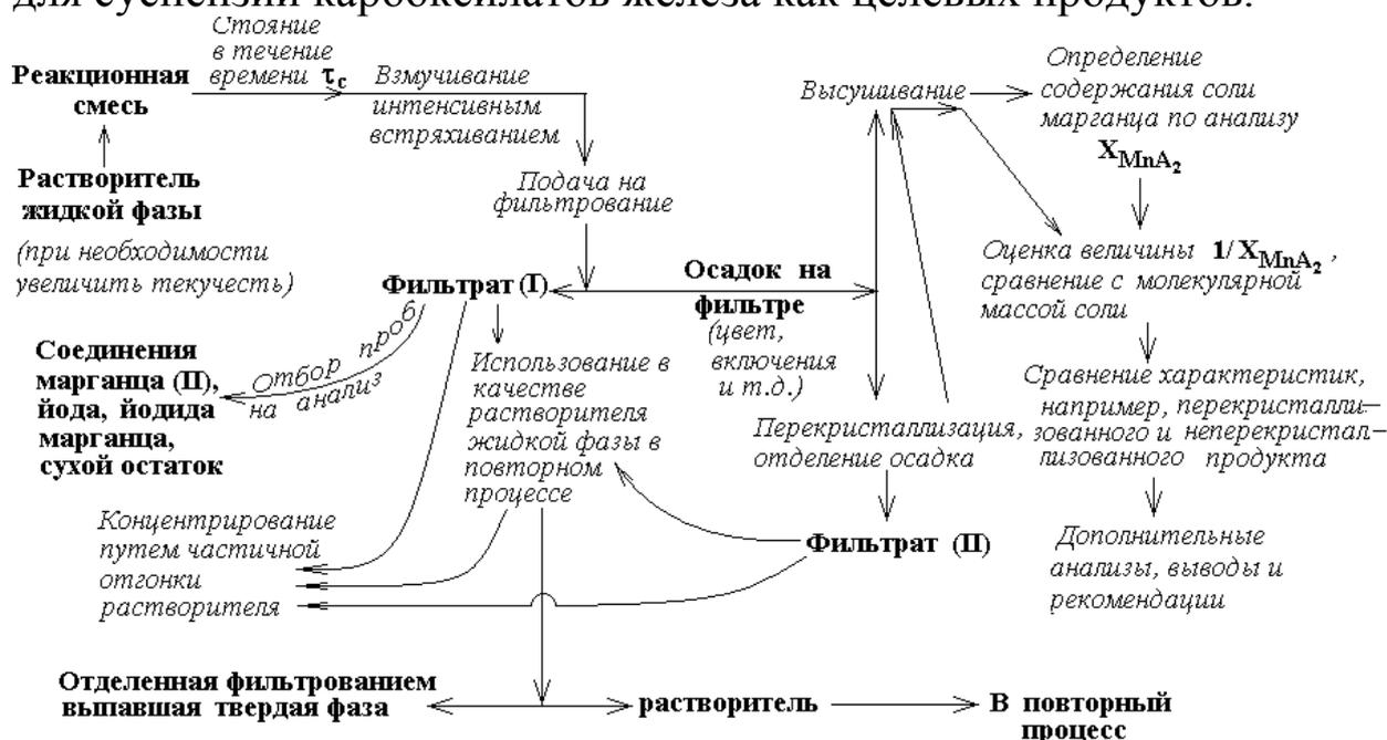
Рисунок 2- Вариант пооперационной схемы разделения реакционной смеси в виде суспензии продукта в жидкой фазе системы
