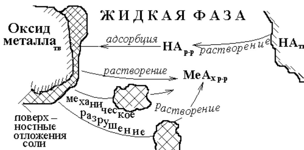
Рис.11 Схема перемещения материальных потоков в реакционной смеси при взаимодействии оксида металла с карбоновой кислотой
