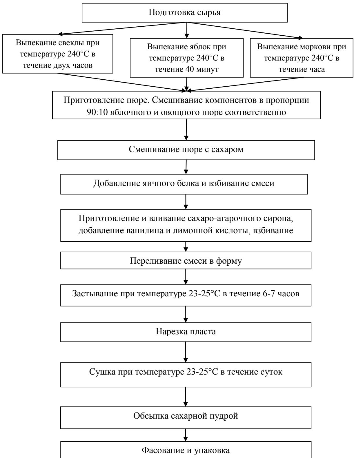
Рисунок 1 – Технологическая схема производства пастилы
