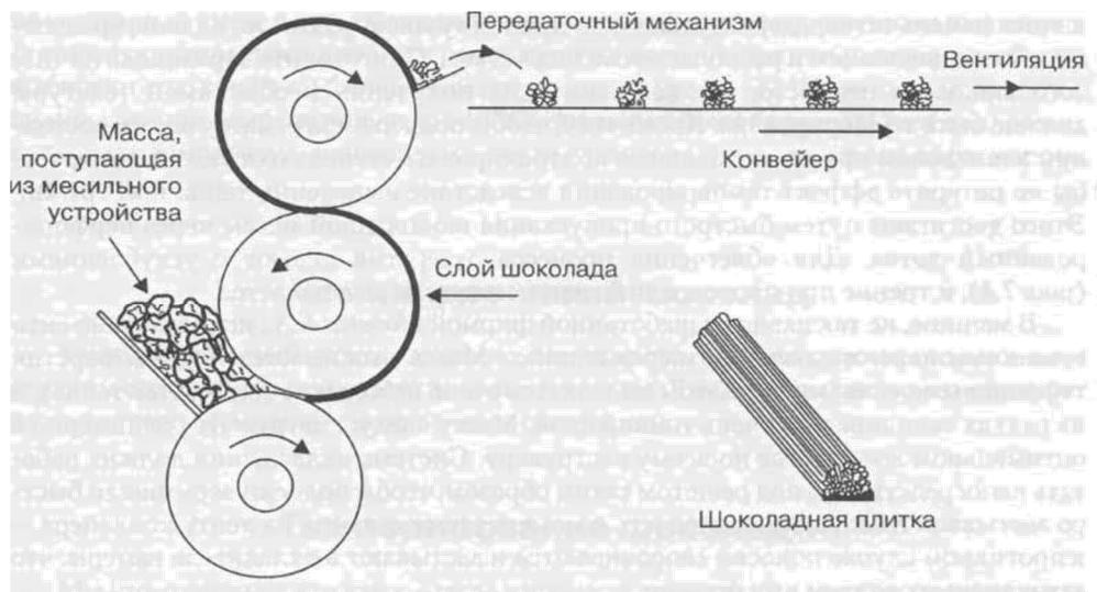
Рисунок 7 Производство шоколадной стружки (хлопьев)
