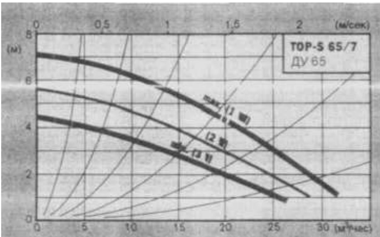
**Рис.П.6.10. Характеристики регулируемых электронасосов типа TOP-S ( $n = 2800$  об/мин, крутая характеристика)**
