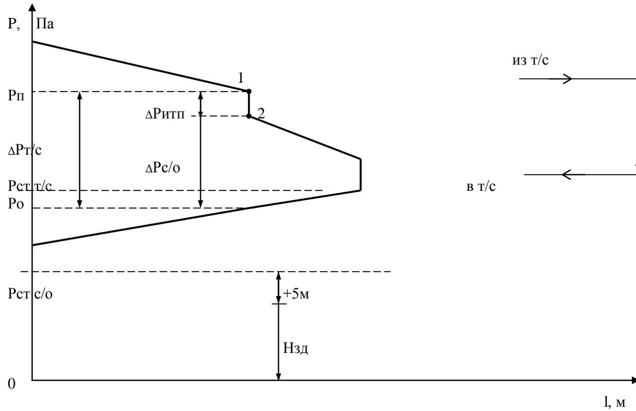
Рис. 4. Пьезометрический график при АУУ с элеваторным смешением
