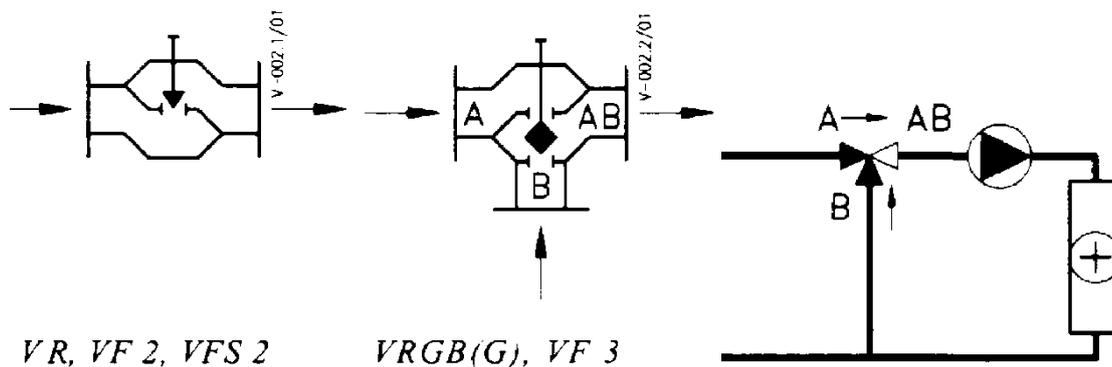
Рис. П.7.1. Принцип работы регулирующих клапанов.
