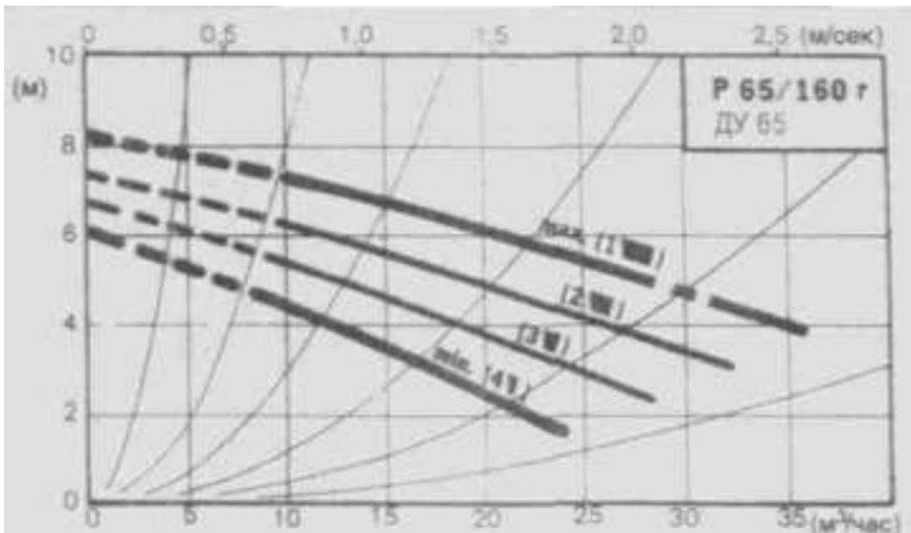
Рис.П.6.15. Характеристики регулируемых электронасосов типорядаР ( $n = 1400$  об/мин, пологая характеристика)
