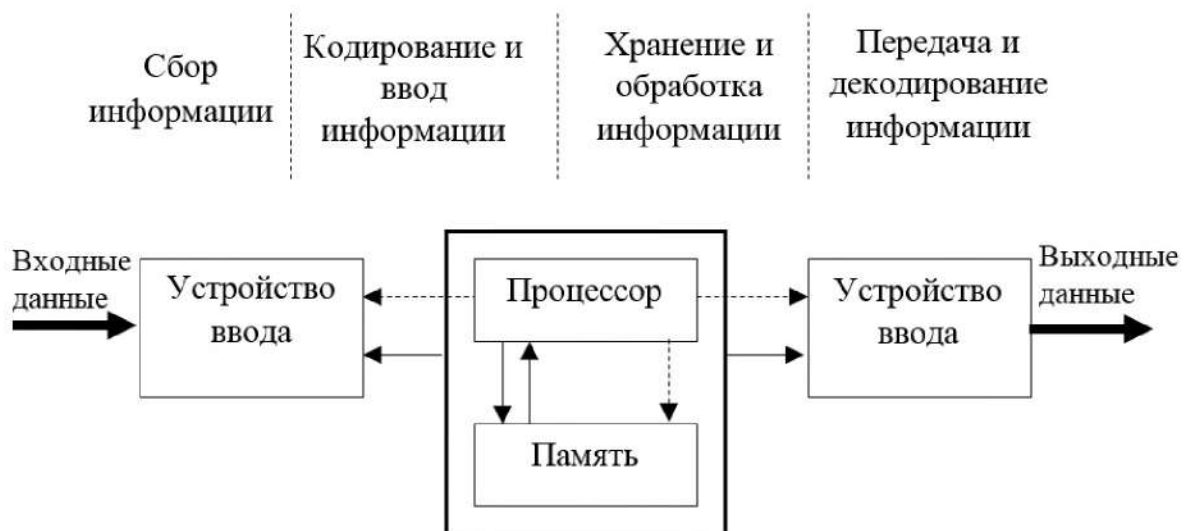
Рисунок 2 - Структурная схема компьютера
