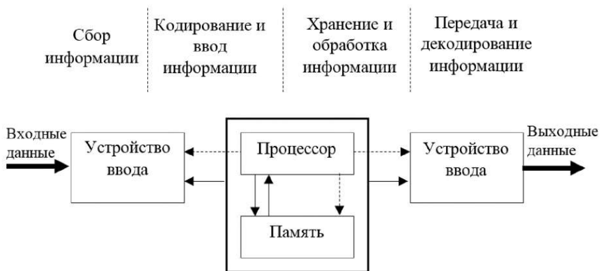
Рисунок 2 - Структурная схема компьютера
