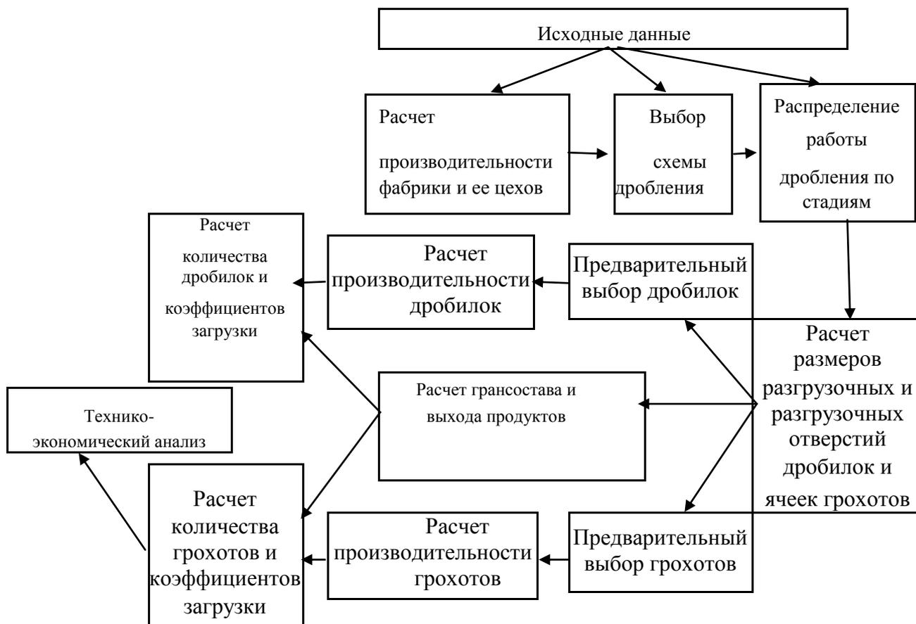
Рис.1 Алгоритм проектного расчета цеха дробления и измельчительного отделения обогатительной фабрики
