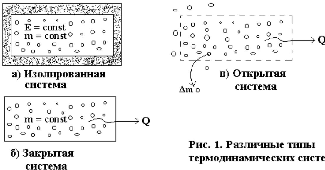
**Рис. 1. Различные типы термодинамических систем**
