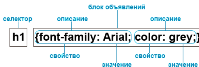
Рисунок 2 – Структура объявления стиля элемента в CSS.
