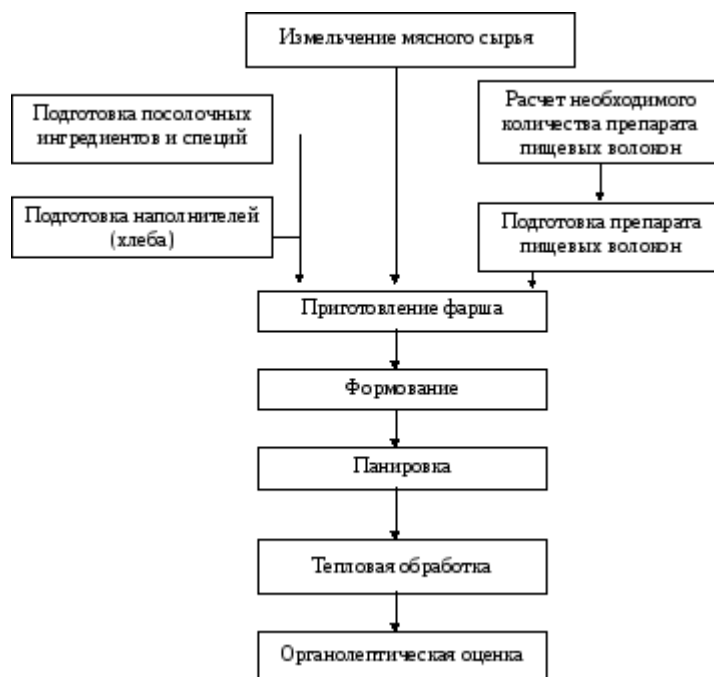
Рисунок 1 - Схема производства котлет
