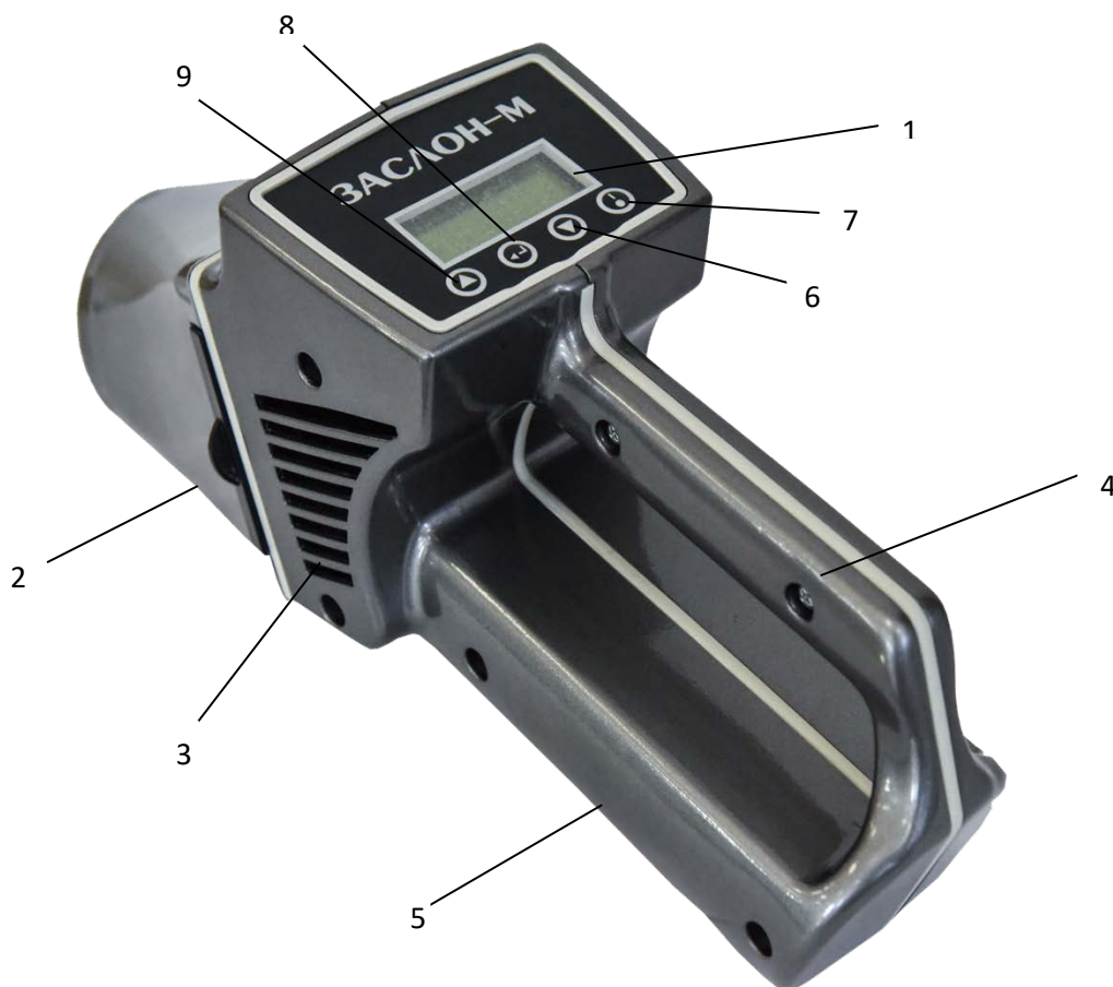
Рис.1. Схема внешнего вида и органов управления мобильного обнаружителя взрывчатых веществ «ЗАСЛОН-М».
